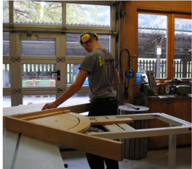
Philipp Lutz bearbeitet die neuen Teile des Mühlrad auf der Tischkreissäge.
