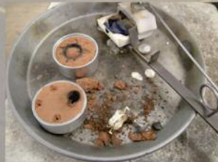
Der Gussrohling wird aus der Form entfernt
