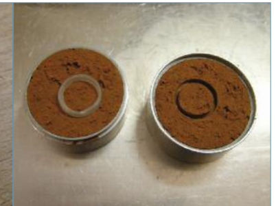
Vom Modell wird ein Negativ im Giess-Sand gemacht
