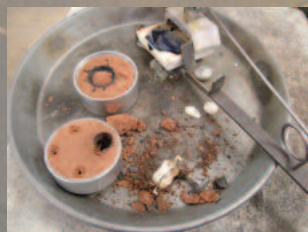
Der Gussrohling wird aus der Form entfernt
