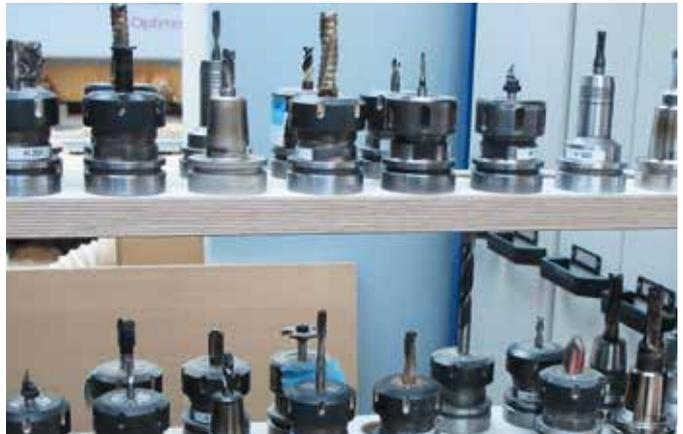
*Komplizierte und vielseitig verwendbare Werkzeuge werden in die CNC-Maschinen eingesetzt.*
