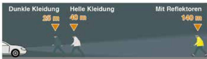
Foto mit eingezeichneten Distanzen zu verschiedenen gut sichtbaren Fussgängern. Grafik: bfu.ch
